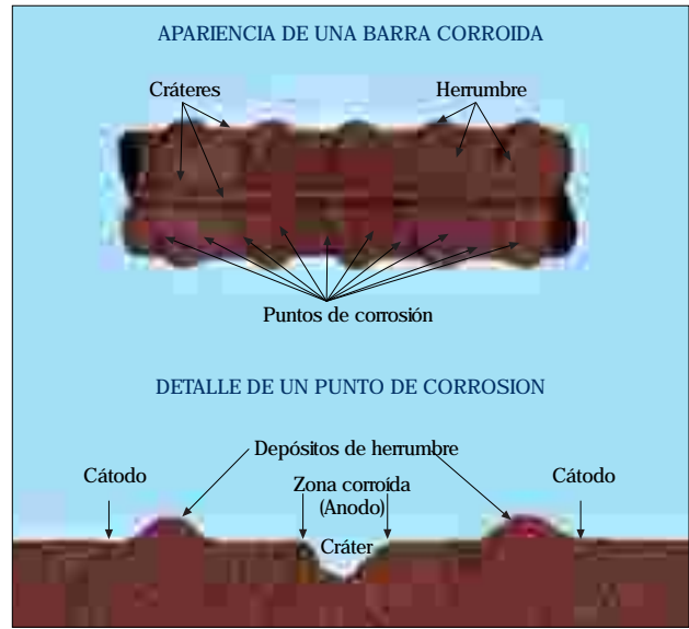
Figura 6.2.2.2: Apariencia de una barra corroída y detalle de un punto de corrosión
