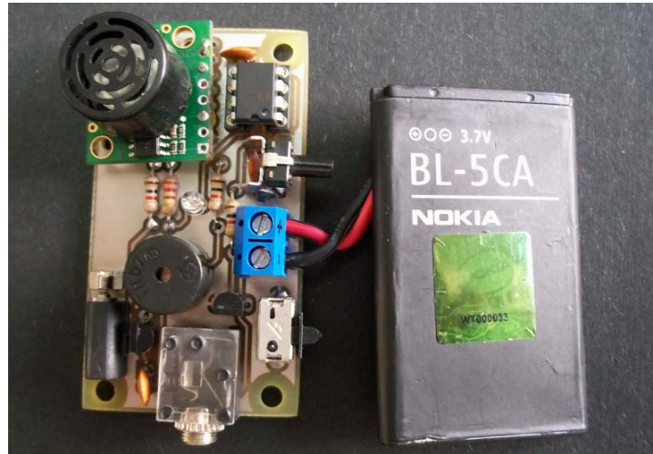
Figura 2.8: Batería Nokia junto a la tarjeta electrónica con todos los componentes.
