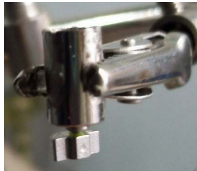
Figura 2.5: Micro motor de 2010 rpm
