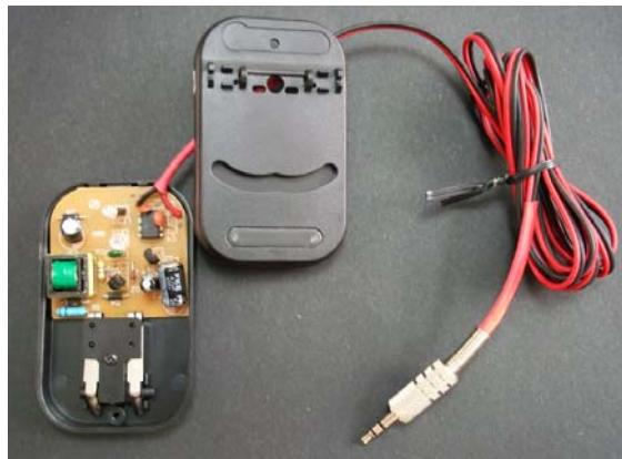
Figura 2.18: Sistema de carga eléctrica para la batería del dispositivo.
