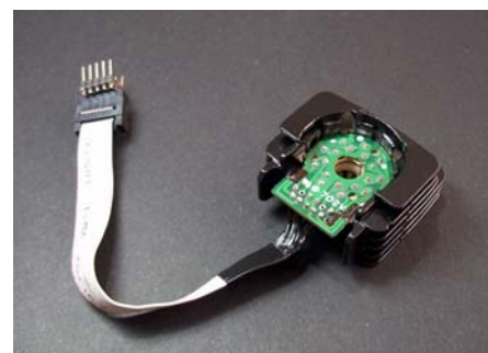
Figura 2.12: Las dos partes principales del cabezal Braille, el de la izquierda es la pieza plástica modificada a 6 puntos, el de la derecha es la carcasa con las 9 bobinas y colocado un bus de datos.
