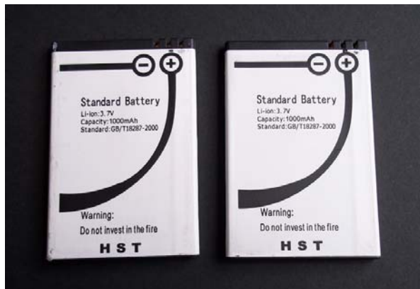
Figura 2.15: Baterías genéricas de celular para conexión en serie.
