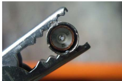
Figura 2.6: Bobina del Micromotor DC con carga desbalanceada.
