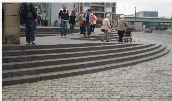
Foto 53 (izq): Los planos inclinados de pendiente igual o inferior a 5% están exentos de los requisitos de rampa. Foto 54 (der): Las rampas combinadas con escaleras deben responder a planos inclinados con pendientes igual o menor a 5% para evitar la obligación de pasamanos.
