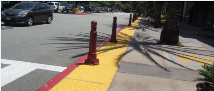
Foto 25 (izq) y Foto 26 (der): bolardos de contraste cromático adecuado y alineados al borde de la calzada
