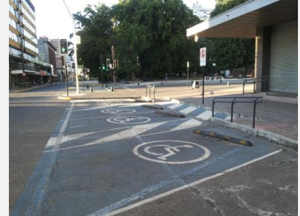
Foto 33: Estacionamientos para PcD en diagonal y conectados a la vereda
