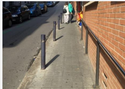
Foto 25 (izq) y Foto 26 (der): bolardos de contraste cromático adecuado y alineados al borde de la calzada
