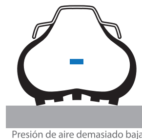
Presión de aire demasiado baja
