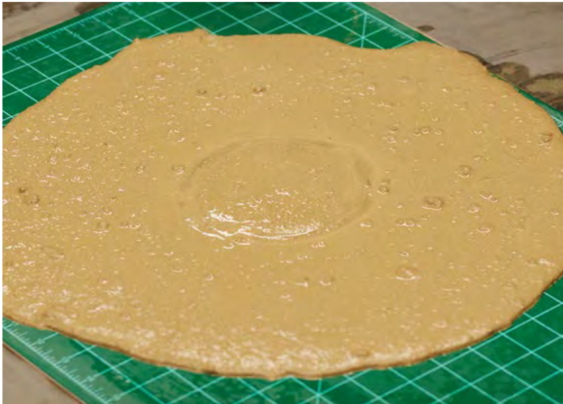
Ensayo de fluidez de CLSM basado en agregados finos reciclados (Serpell, 2011)
