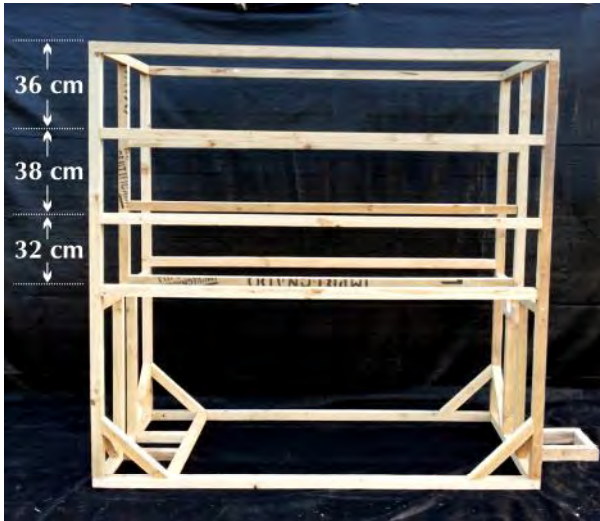
Figura 4. Vista frontal de la estructura, con soportes horizontales para sostener las bandejas.
