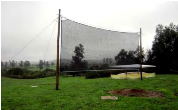
Figura 19. Sistema “atrapanieblas” y de agua lluvia, de 40 m 2 de superficie de captación. INIA-Hidango, comuna de Litueche. Región de O’Higgins.
