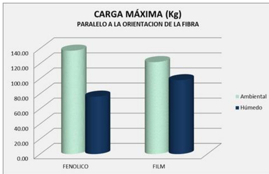
Grafico N° 3. Carga Máxima promedio paralelo a la fibra y según condición inicial de ensayo (kg/cm 2 )
