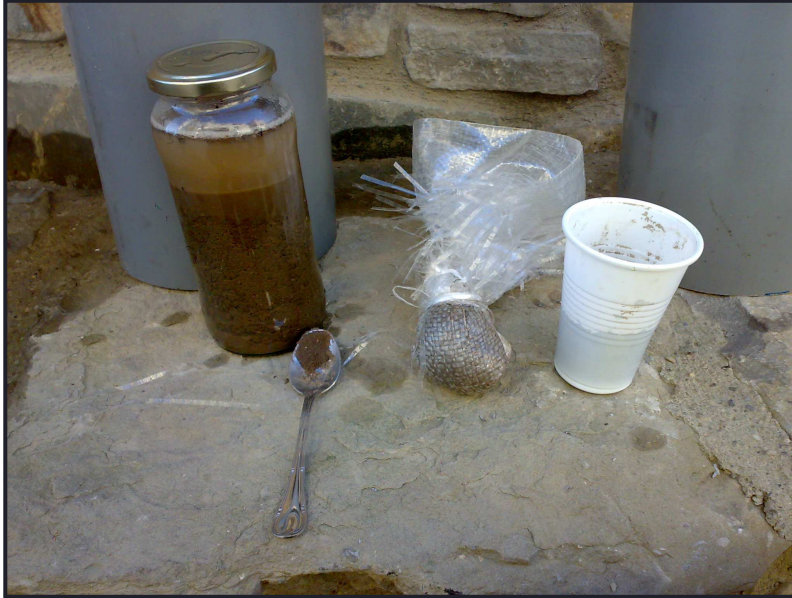
Foto1: Pruebas en vaso de plástico o en un trozo de saco de rafia de los usados en el domo. Y un tarro con tierra para ver su granulometría.
