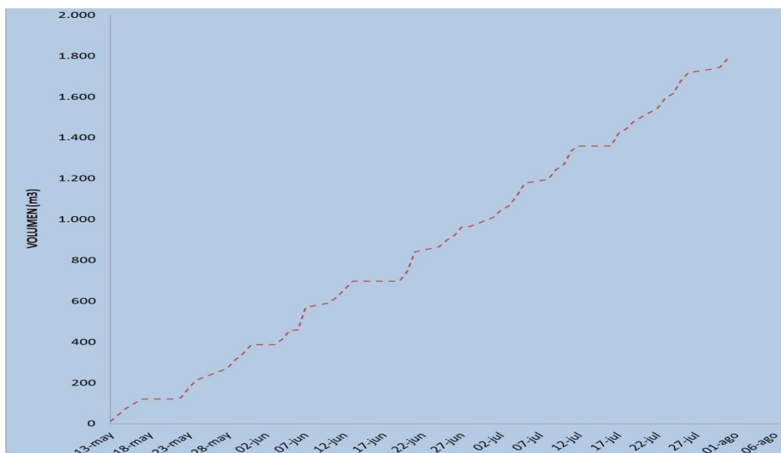
GRÁFICO N° 7: Curva Hormigón Torre Obra Espacio Condell
