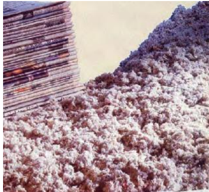
Fig. N°25 Copos de celulosa.
