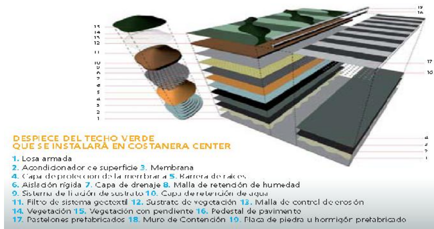
Fig. N°54 Secciones de la cubierta ajardinada.
