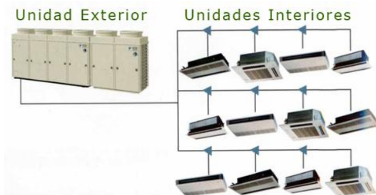
Fig. N°34 Funcionamiento del sistema de VRV.
