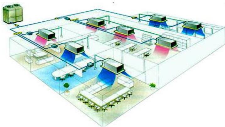
Fig. N°34 Funcionamiento del sistema de VRV.
