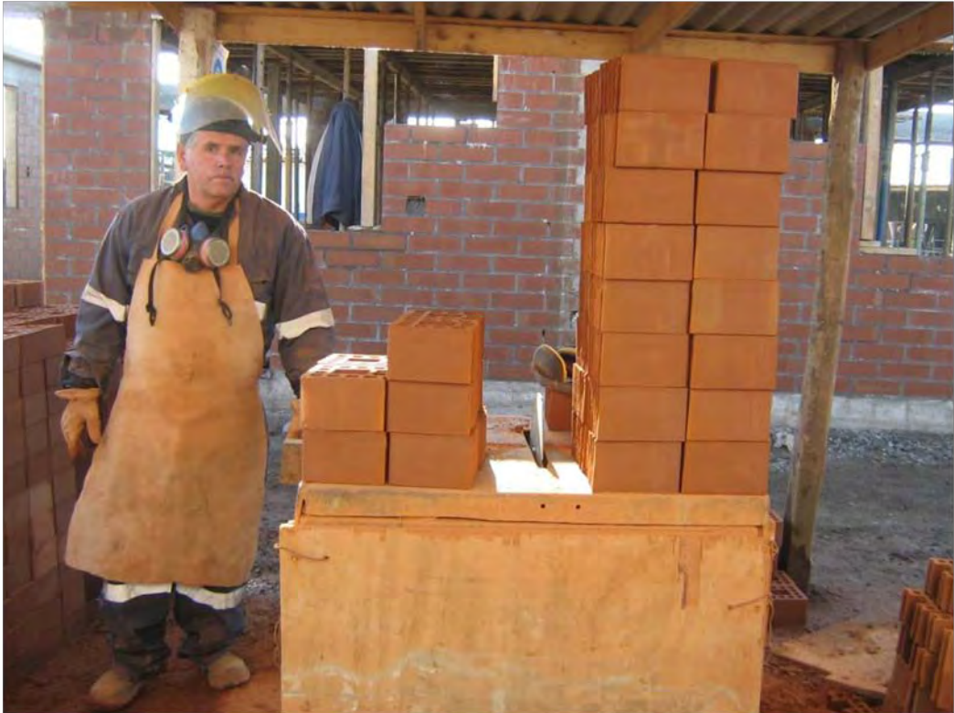
Fig.76.- Banco de corte de ladrillos.
