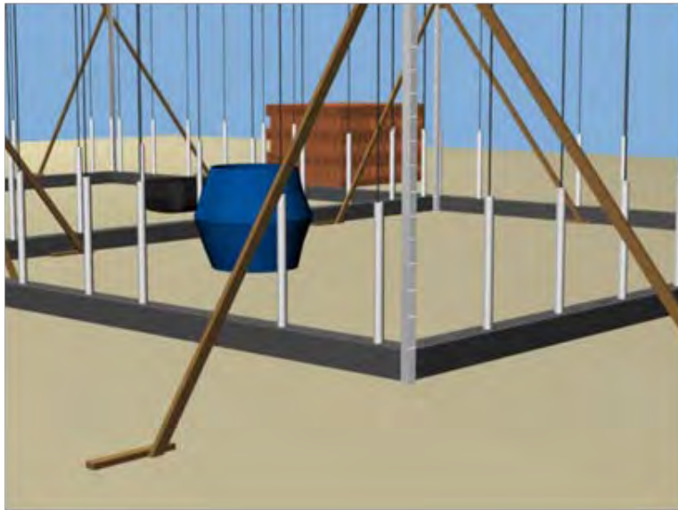
Fig.70.- Detalle de escantillones.
