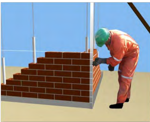
Fig.90 y 91.- Confección del muro por hiladas.
