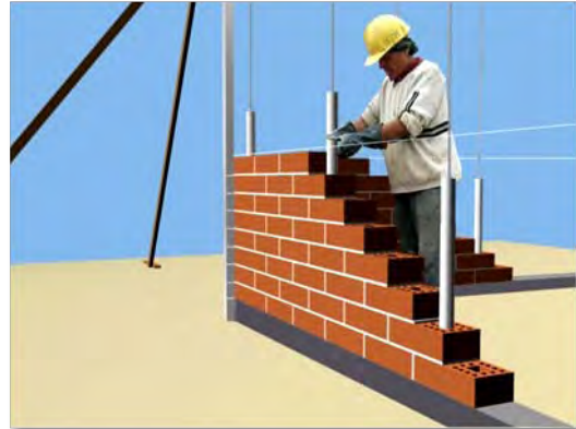
Fig.90 y 91.- Confección del muro por hiladas.
