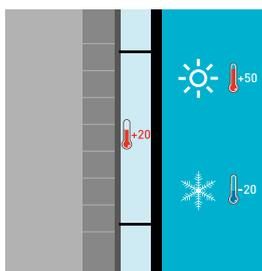
**Control atmosférico.** La fachada ventilada ofrece una protección extra contra la lluvia, la exposición al sol extrema y la humedad, evitando así daños en el aislamiento y la consiguiente pérdida de sus propiedades térmicas.
