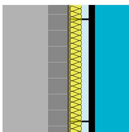
**Posibilidad de incluir grandes espesores de aislamiento térmico** en la cámara de aire: los sistemas estándar permiten un aislamiento térmico de hasta 26 cm ofreciendo una envolvente térmica altamente eficiente que puede minimizar la pérdida de calor y reducir a la vez la demanda térmica en el interior del edificio. Además, pueden ampliarse espesores aún mayores a petición del proyectista.
