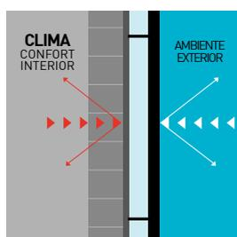
**El efecto positivo de una cámara de aire ventilada** es especialmente útil en climas tropicales. El calor acumulado dentro de la cámara es expulsado mediante el efecto chimenea, reduciendo así la carga térmica del edificio y, por consiguiente, la demanda energética para refrigeración. En climas más fríos y en temporadas de invierno, esta cámara también supone una gran ventaja al convertirse en un amortiguador térmico entre la envolvente aislante del edificio y el aire frío del exterior.
